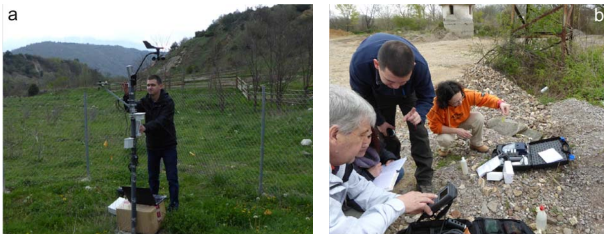
Фиг. 2: (а) проверка състоянието на автоматична климатична станция в основата на стената на хвостохранилището във Вълче дере, Елешница и (б) определене на физикохимични параметри на подземни води в терасата на река Марица
